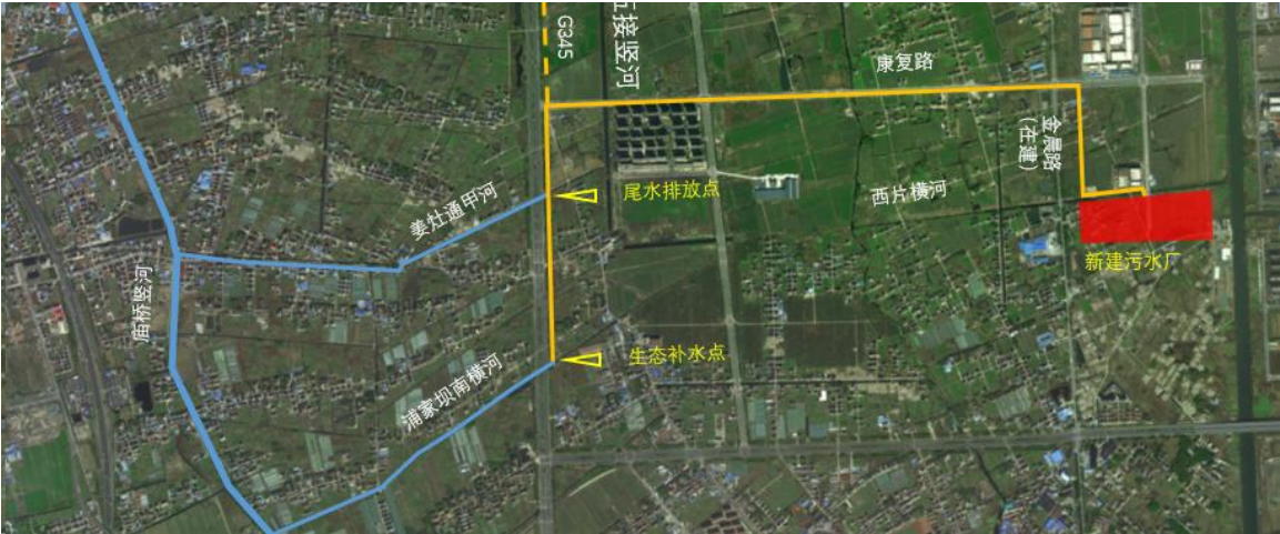
图 3.1-4 污水厂尾水管道方案图
